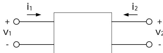
**figura 85 - Doppio bipolo per il calcolo dei parametri  $y$**
