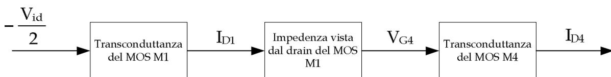
**figura 96 – Calcolo della funzione di trasferimento relativa al circuito formato da M1, M3 e M4**
