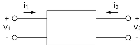
figura 79 – Doppio bipolo per il calcolo dei parametri g
